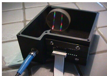
紧凑型设计 - 内置高性能光栅
