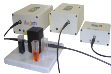
UV-VIS-NIR 系统覆盖280-1700nm带有试管附件
