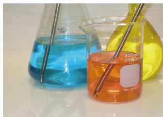
浸入式探针用于测量颜色, 浓度, 流动的液体
